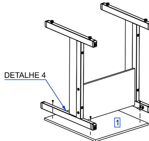
Inicie montando a estrutura: fixe o pé lateral direito (3), ao painel frontal (2) e pé lateral esquerdo (4) como indicam as imagens. Utilizar Parafuso estrutural (A).
