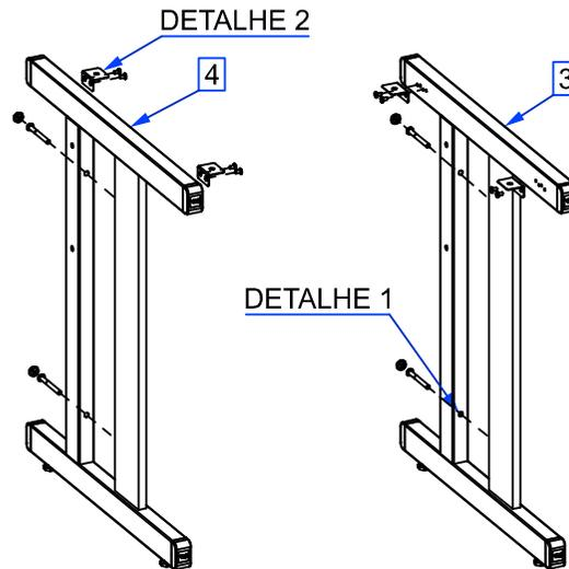
Na montagem dos pés laterais (3 e 4) utilizar o parafuso estrutural (D).
